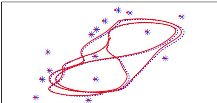
Amers en position ● et trajectoire réelle du véhicule (rouge). Estimation des amers (\*) et de la trajectoire (bleu) par l'**EM en ligne**
