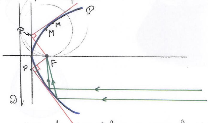
• Toujours pour la parabole, un rayon lumineux "arrivant de l'infini" se réfléchit sur (l'intérieur de) la parabole pour converger vers le foyer  $F$ . Application : le four solaire d'ODEILLO (P.O.).
