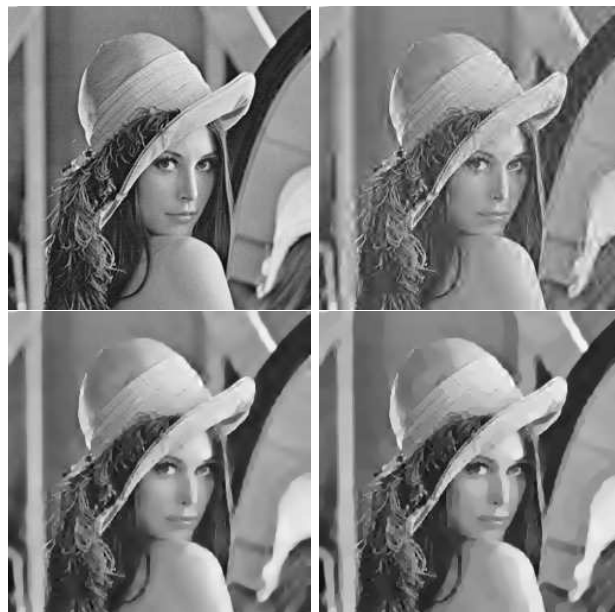
FIG. 2 – Reconstruction d'une image après quantification des coefficients d'ondelettes Daubechies 9-7. HG : original - HD : compressée - BG : Décompressée avec \mu = 0.01 - BD : Décompressée avec \mu = 0.0001
